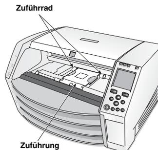
6. Wischen Sie mit dem im Reinigungssatz des Imagers enthaltenen Reinigungstuch für die PLATEN ROLLER (Druckplattenwalze) um jedes Zuführrad herum. Das Reinigungstuch kann sich verfärben.
